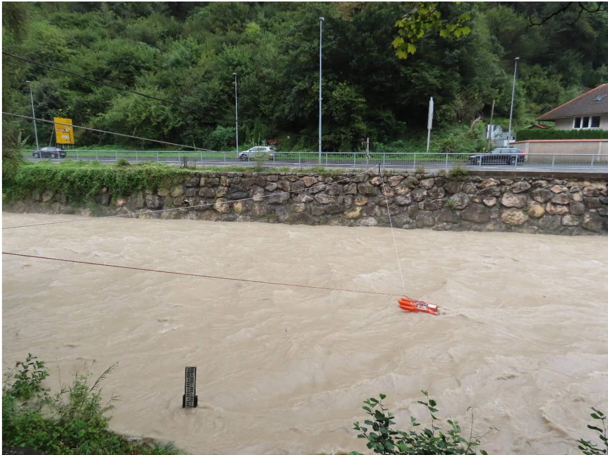
Slika 2.2: Hidrometrična meritev s pomočjo vrvine premostitve na Kamniški Bistrici v Kamniku (fotografija: arhiv ARSO)
